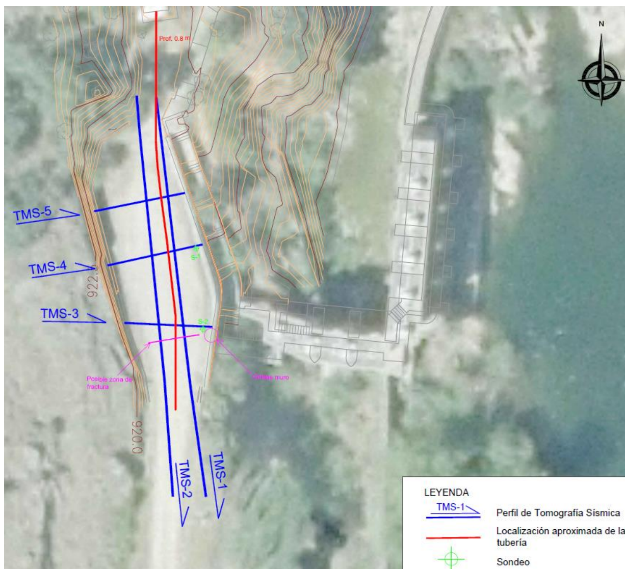
Figura 67.- Planta de campaña geotécnica ejecutada en la futura plataforma de trabajo de la grúa, zona superior del muro de mampostería con patologías detectadas.
